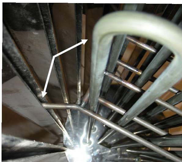
Immagine 3 Installazione del supporto per gli elementi riscaldanti
