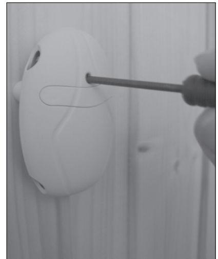
Figura 15. Botón de restablecimiento del seguro de recalentamiento Figura 15. Pulsante di ripristino per il limitatore termico di sicurezza
