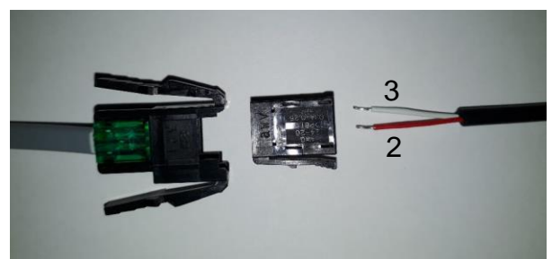
Lämpötila sensorin kaapelien kytkentä
